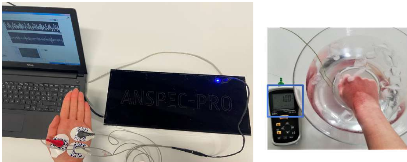
Fig. 2. Experimentul de măsurare a durerii a) plasarea electrozilor pe palma voluntarului și dispozitivul ANSPEC-PRO b) plasarea mâinii în apă cu gheață la 16°C.
